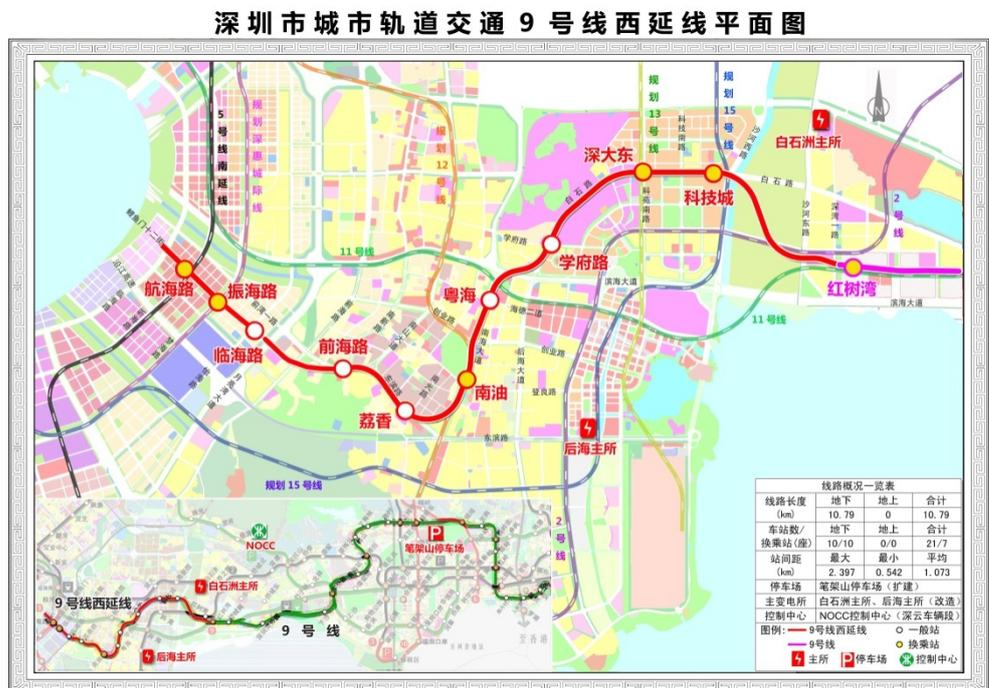
座换乘车站，全部为地下线路。在 9 号线笔架山停车场扩建停车列位满足停车需求；改造后海及白石洲主所，共用 NOCC 控制中心，是中心城区内成熟片区与重点发展片区之间的局域线。本项目计划于 2015 年年底开工建设，2020 年建成通车，其开通将极大方便沿线公众的出行。
